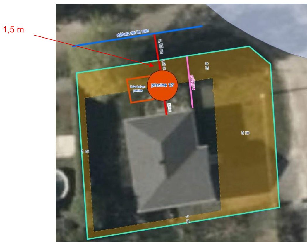
Croquis d'implantation préparé par l'inspectrice municipale
